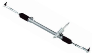
柱式助力EPS手动转向器
